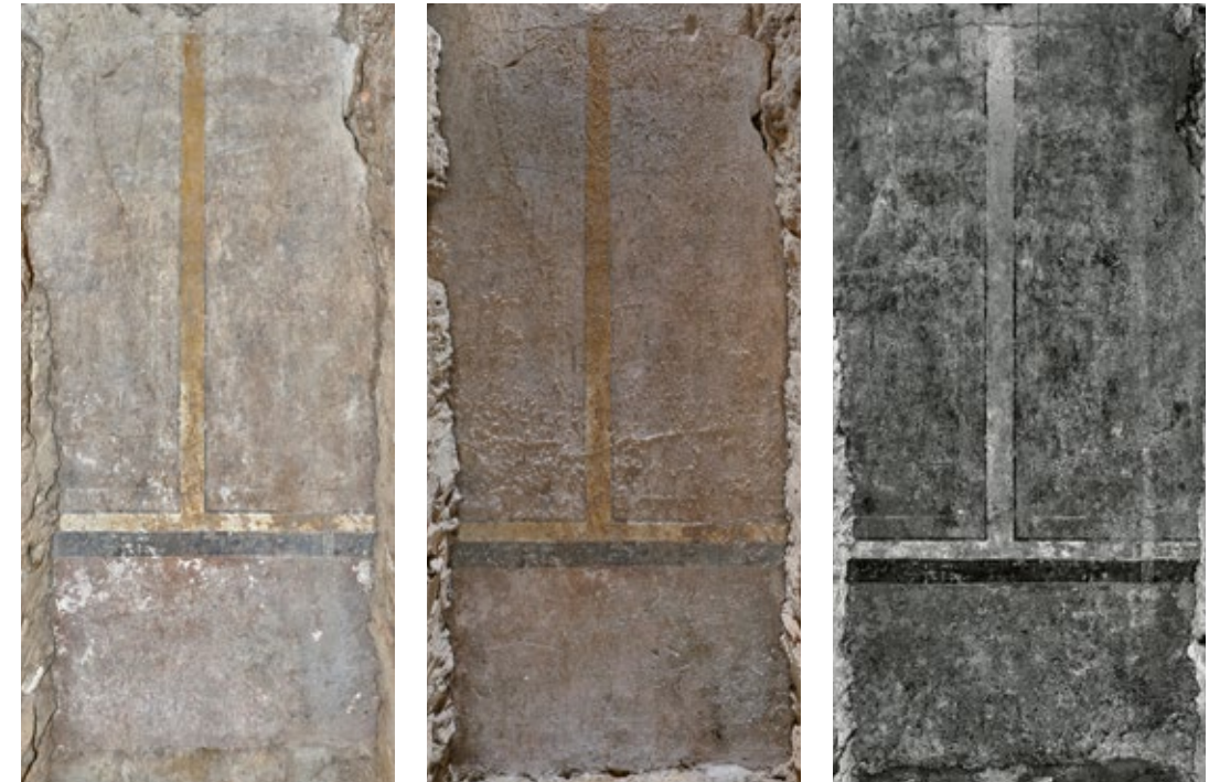
24 | Von der Fokus GmbH, Leipzig, maßstäblich entzerrte Multispektralaufnahmen (Messbilder) der römischen Wandmalerei im Auflicht (links), Streiflicht (Mitte) und unter UV-Fluoreszenz bei 380 nm (rechts)
