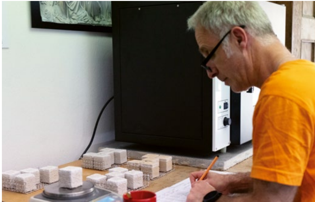
9 | Untersuchungen an Prüfkörpern der verwendeten Werk trockenmörtel
