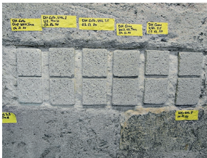
7. Kleinformatige Testflächen farblich und strukturell dem Gestein angepasster Restauriermörtel
