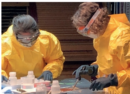
22. Die Glasmalerinnen in Schutzmontur beim Ätzen
