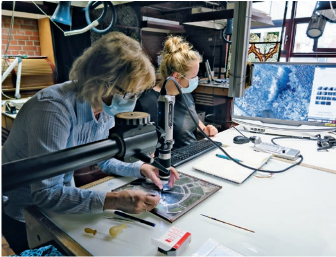
27. Lichtmikroskopische Untersuchung von Beschichtungen mit »Glas-ORMOCER®«
