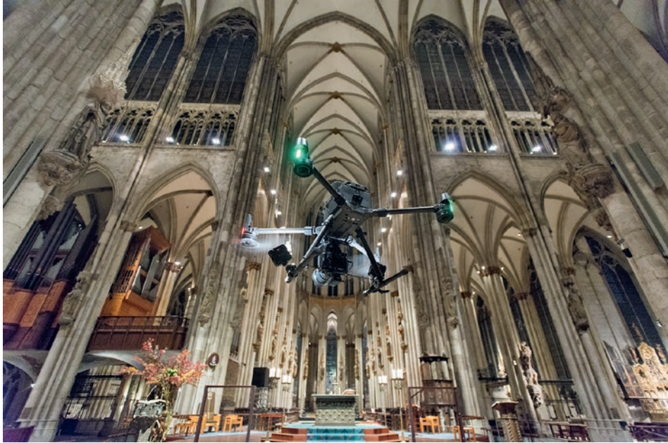
5. Befliegen des Dominnenraumes mit einer Drohne für das 3-D-Modell
