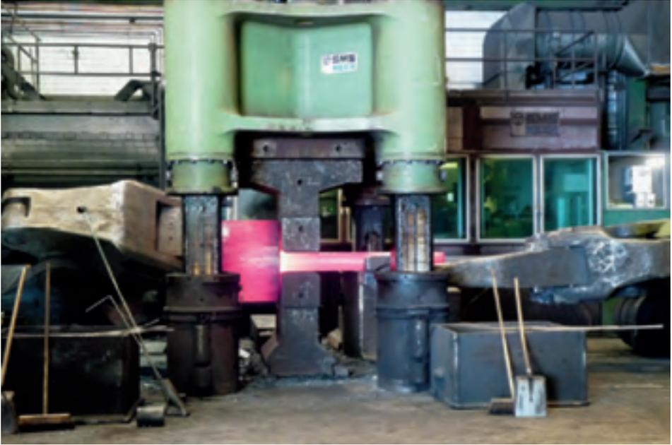
14. Schmieden der Klöppelaufhängung für die Petersglocke. Handhabung durch zwei Manipulatoren, links von den Pressensätteln das Material für die Lagerböcke und die Druckplatte zwischen den Sätteln und rechts davon die ausgeschmiedete Hängestange.
