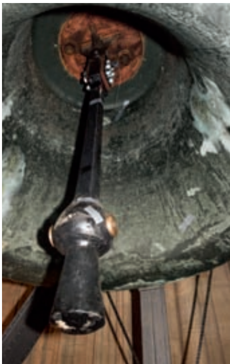
12. Pretiosa-Glocke mit Sensoren an der Innenwand und am Klöppel.
