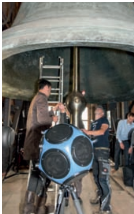
13. Aufzeichnung des Läutewinkels und sämtlicher Frequenzbereiche der Petersglocke.
