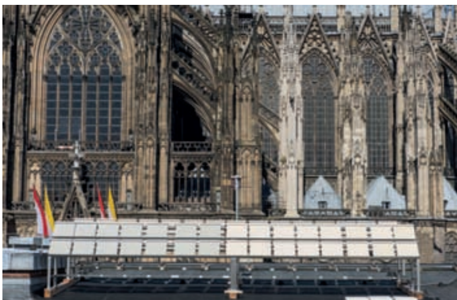
27. Expositionsgestell für Gesteinsproben auf dem Dach des Kuriengebäudes am Roncalliplatz.
