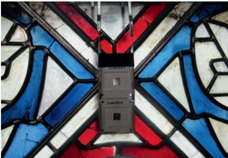
15. Glasdosimeter des ISC Würzburg an Fenster S VIII.
