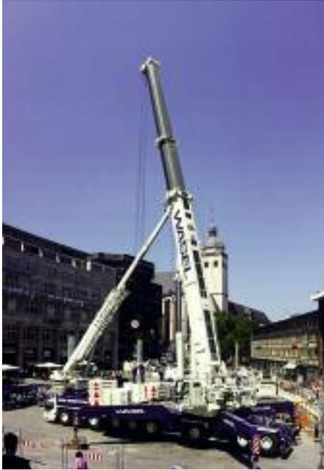
15. Aufbau des Kranes für die Abnahme des Hängegerüsts.
