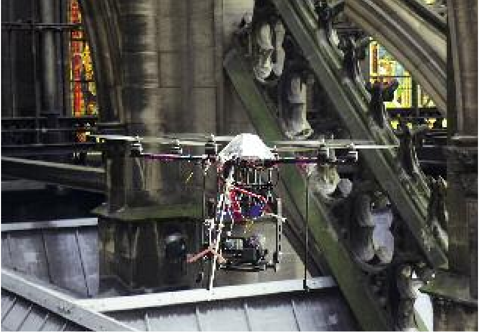
21. Einsatz eines Hexakopters bei Dreharbeiten des WDR im Strebewerk des Domes.
