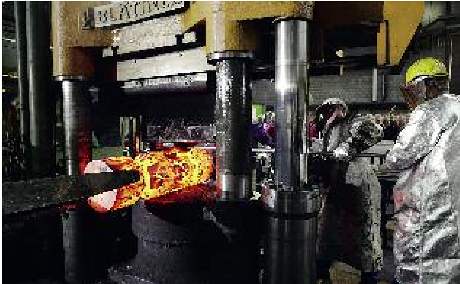
11. Die Rohform des neuen Stahlklöppels für die Petersglocke in einer der Schmiedepressen der Firma Rosswag.
