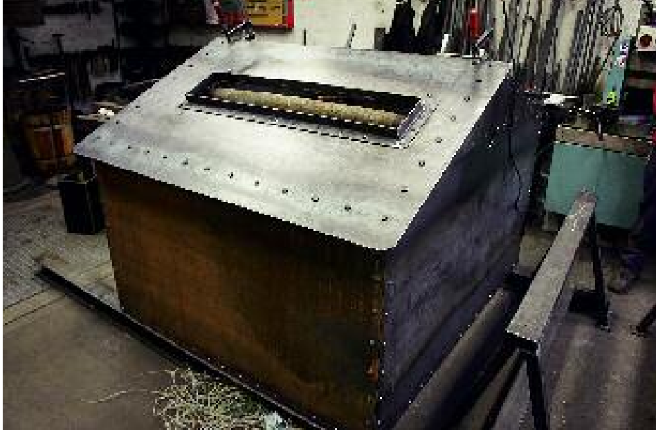
8. Neues Gehäuse der eisernen Seilwinde auf der 100-Meter-Ebene des Südturmes.
