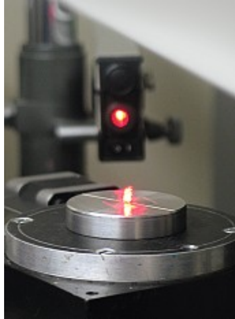
25. Glasprobe auf feinmotorisch gesteuerter Meßapparatur für Computertomographie, ELETTRA Synchrotron-Labor, Triest.
