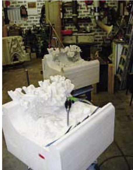
3. Werkstück mit Laubfries für die Verblendung der sogenannten Ziegelplombe am Strebepfeiler F 1 des Nordturmes.
